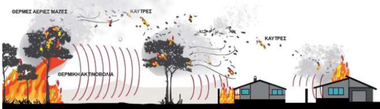
Σχέδιο 1. Τρόποι ροής της θερμότητας σε μια δασική πυρκαγιά, που εξελίσσεται πλησίον κτιρίων και απεικόνιση τρόπου μετάδοσης δασικής πυρκαγιάς με μεταφερόμενες καύτρες σε κτίρια (R. Blanch /CSIRO, 2021)
